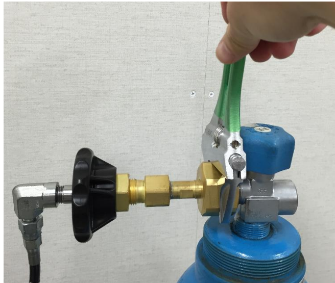
図 5 : ガスボンベと継手の接続
