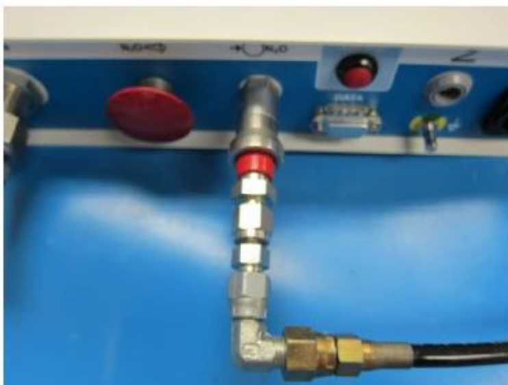
図 4：N 2 O ガス吸気口接続部
