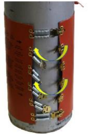
図 7：シリンダーヒーターバンドの固定 (張力ばね固定具をすべて留めて下さい。)
