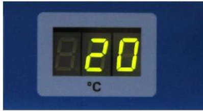
図 15 : 冷凍手術用ハンドピース温度表示灯
