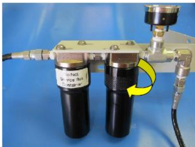
図 21 : ガスフィルターハウジングの取り外し
