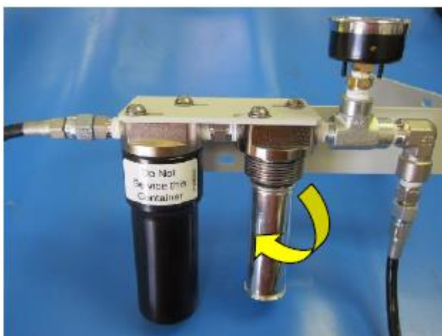
図 22 : ガスフィルターカートリッジの取り外し
